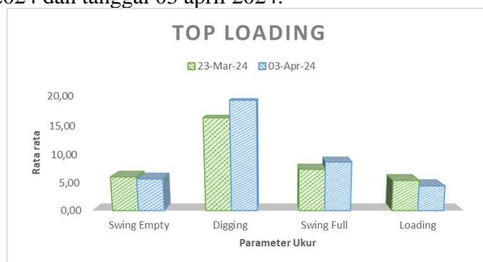
Gambar 1. Grafik perbandingan antara hasil rata rata rata dari swing empty, digging, swing full, loading dengan pola pemuatan Top Loading.
