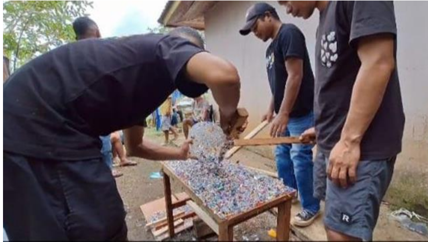
Gambar 4. Proses pembuatan komposit kayu dan Pencampuran resin.
