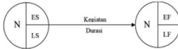
Gambar 1 contoh penggambaran CPM untuk satu item pekerjaan (Sumber: Bangun, T.D., Irwan, H., dan Purbasari, A., 2016)
