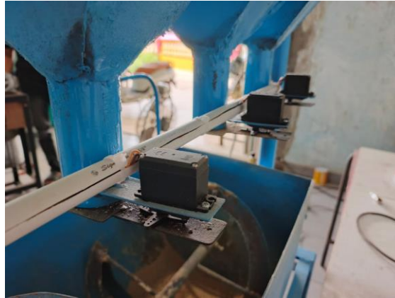
Gambar 13 Motor Servo Membuka Jalur Bahan Pakan
