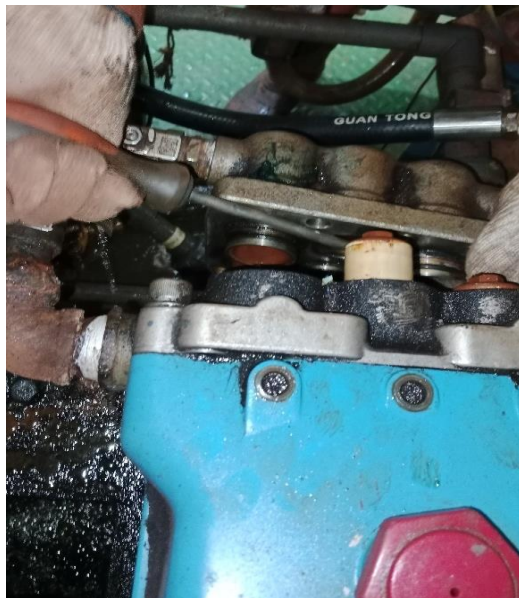
Gambar: 6. Perbaiki pada O-ring head connection Sumber: FC. Winning Sunrise
