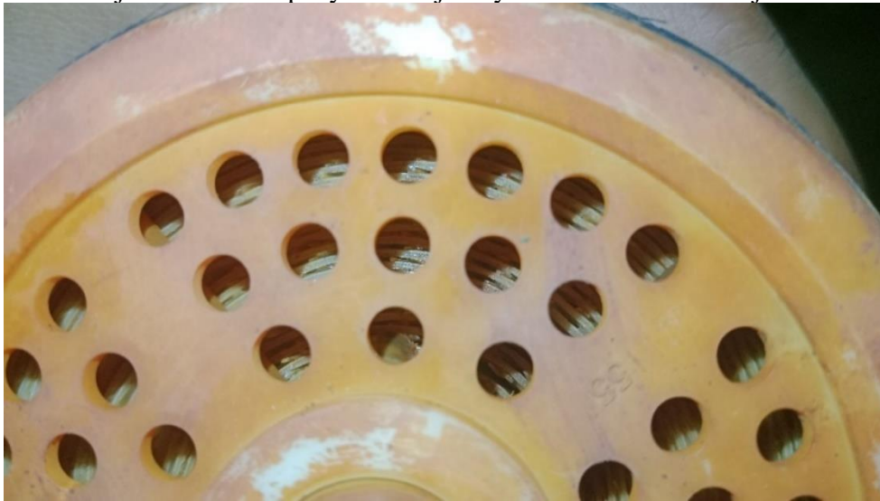
Gambar: 10. Endapan kotoran pada membran cell
