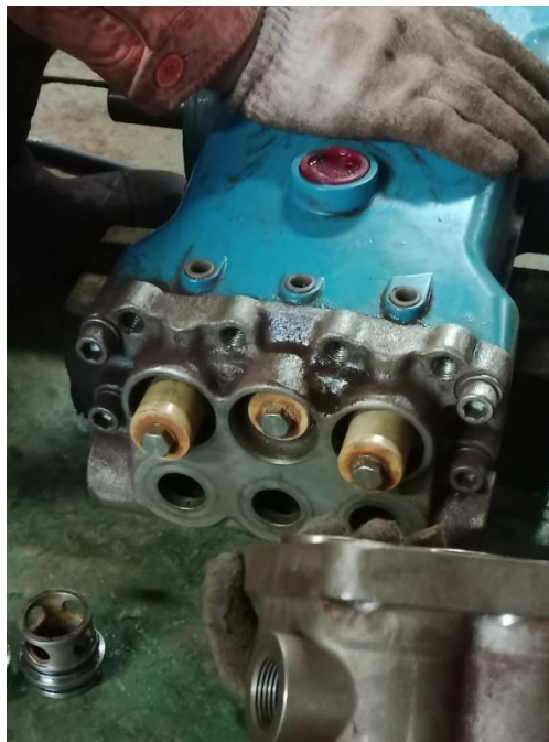
Gambar: 14. Perbaikan pompa high pressure
