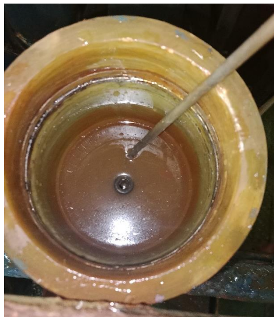
Gambar: 9. Endapan pada housing membran Sumber: FC. Winning Sunrise
