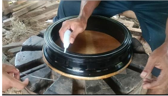
Gambar 43 Pemasangan Kawat ke Bibir Bawah Rapa'i (Sumber: Dokumentasi Ompusunggu, 2025)
