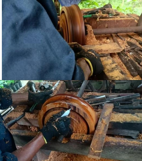
Gambar 32 Membentuk Motif Pada Kayu Merbau (Sumber: Dokumentasi Ompusunggu, 2025)
