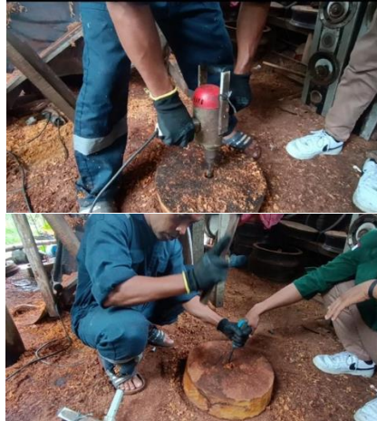
Gambar 28 Melubangi Bagian Tengah Lingkaran Kayu Merbau (Sumber: Dokumentasi Ompusunggu, 2025)
