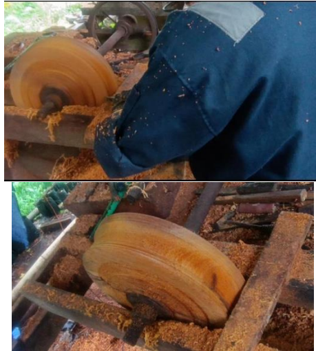
Gambar 31 Pembentukan Motif Dasar Kayu Merbau (Sumber: Dokumentasi Ompusunggu, 2025)
