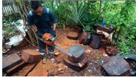
Gambar 27 Membentuk Lingkaran Balok Kayu Merbau (Sumber: Dokumentasi Ompusunggu, 2025)
