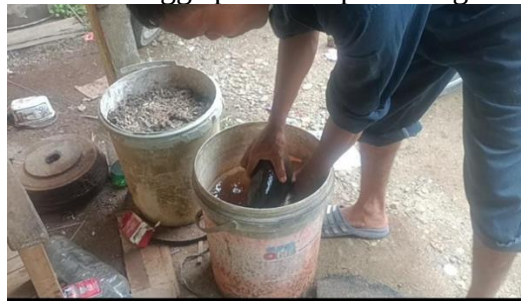
Gambar 39 Perendaman Kulit Kambing (Sumber: Dokumentasi Ompusunggu, 2025)
