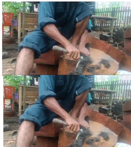
Gambar 37 Pembuangan Bulu Pada Kulit Kambing (Sumber: Dokumentasi Ompusunggu, 2025)
