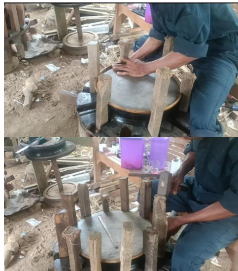
Gambar 41 Memasukkan Cincin ke Mulut Rapa'i (Sumber: Dokumentasi Ompusunggu, 2025)
