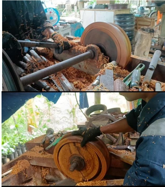
Gambar 33 Pembuangan Kayu Pada Bagian Dalam (Sumber: Dokumentasi Ompusunggu, 2025)
