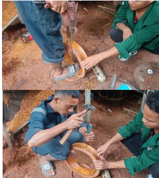
Gambar 35 Pembuatan Lubang Tempat Kerincing (Sumber: Dokumentasi Ompusunggu, 2025)
