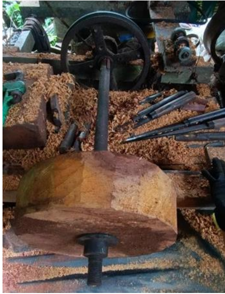
Gambar 29 Pemasangan Kayu Merbau ke Mesin Pemutar (Sumber: Dokumentasi Ompusunggu, 2025)
