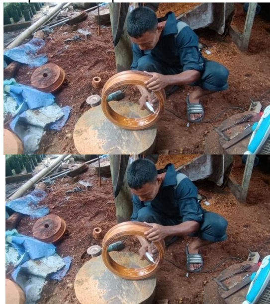
Gambar 34 Penghalusan Seluruh Bagian Kayu (Sumber: Dokumentasi Ompusunggu, 2025)
