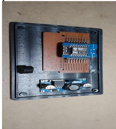
Gambar 4 Pemasangan ESP8266 pada board dan penempelan regulator pada box
