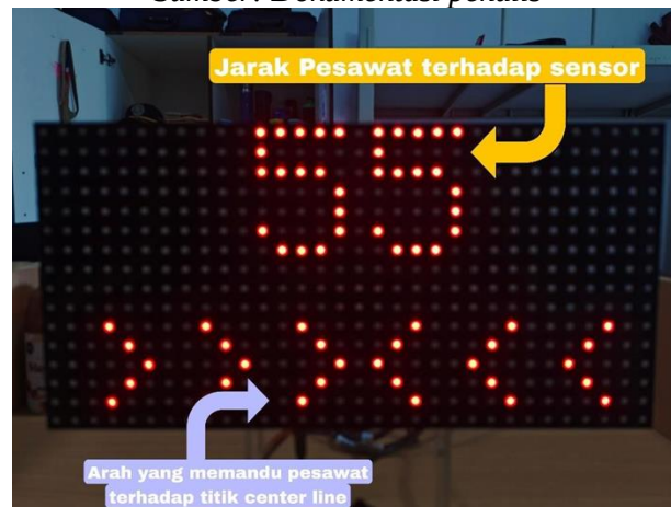
Gambar 19 Keterangan Display pada LED P10 Sumber: Dokumentasi Penulis
