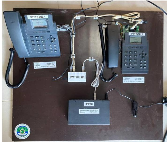
Gambar 14. Instalasi Peralatan IP PABX dengan IP Phone
