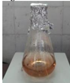
Gambar 3 Nanopartikel perak hasil sintesis. Terbentuknya nanopartikel perak ditandai dengan adanya perubahan warna larutan menjadi jingga kecoklatan.
