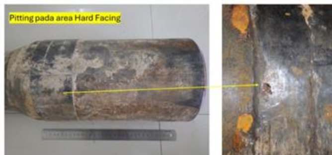
Gambar 3. Kondisi Drill Pipe C yang memiliki lubang pada area hard facing.
