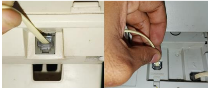
Gambar 8 Kabel RJ-11 pada Telepon
