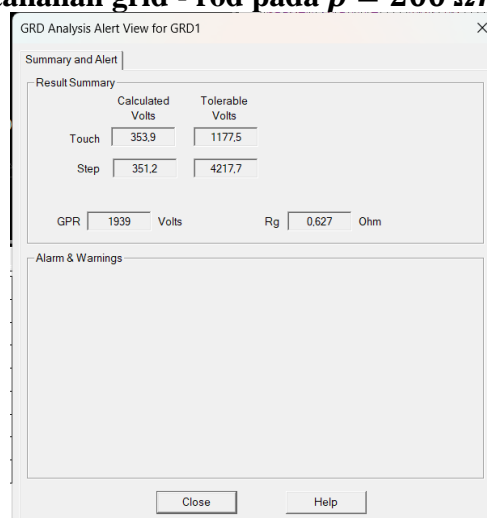
Gambar. Hasil simulasi sistem pentanahan grid - rod pada \rho = 200 \Omega m
