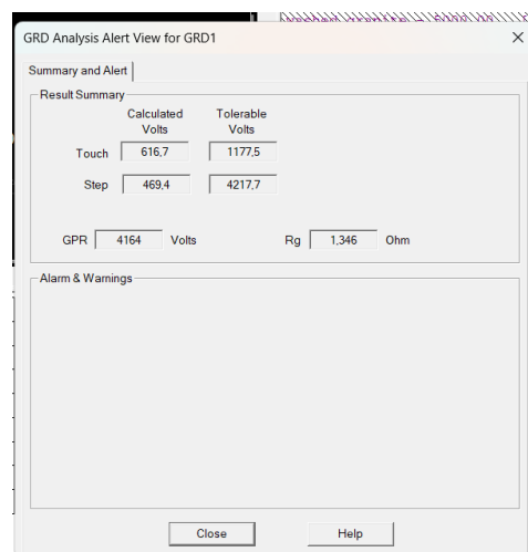
Gambar. Hasil simulasi sistem pentanahan grid pada \rho = 200 \Omega m
