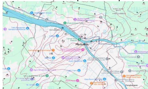
Gambar 23 Peta Google Maps interpolasi rata-rata kepadatan sambaran petir tahun 2018-2021 di Kota Pontianak dan sekitarnya
