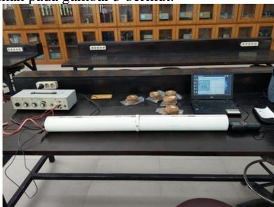
Gambar 5. Pengujian koefisien absorpsi sampel
