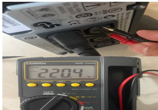
Gambar 10 Pengukuran Output UPS Tanpa beban Sumber : Penulis, 2024
